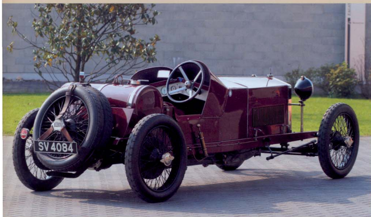
リアサスペンションは半楕円リーフのキャンテレバ式、トルクチューブ・ドライブだ。フロントブレーキの備えはない。
